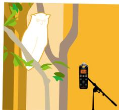
屋外での録音には録音プリセットのFIELDがお勧めです。野鳥など自然の音を録音する場合はREC LEVEL=30以上、列車や飛行機など比較的大きな音を録音する場合はREC LEVEL=20前後に設定します。屋外ではポップノイズが生じやすいため、市販のウインドスクリーンの使用をお勧めします。
