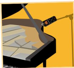
ピアノの録音には録音プリセットのOFFがお勧めです。PR7をピアノの外周のくぼみの位置に設置しピアノ線の中央にマイクを向けることで、高音から低音まですべての音域がマイクのカバーエリアに含まれバランス良く録音できます。市販のマイクスタンドアダプタを使い、PR7をマイクスタンドに立てることも可能です。
