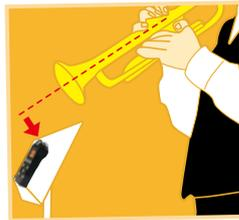
管楽器の録音には、録音プリセットのNEARがお勧めです。譜面台をお持ちの方は、譜面台を活用してレコーダーを設置し録音することも可能です。ホーンとマイクが一直線にならぶと、ボーカル同様ポップノイズが録音されることがあるため、位置をずらして設置することをお勧めします。図のように譜面台を使って設置することもできます。
