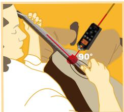
アコースティックギターの録音には録音プリセットのNEARがお勧めです。PR7のマイクがギターホルルのをねらいギターに対して垂直になるよう、レコーダーを設置します。メロディを録音する場合は図のようにホルルに近い位置に設置すると低域の豊かな響きが得られ、リズムを録音する場合は図よりもややネック側に設置するとよりシャープな音を得られます。
