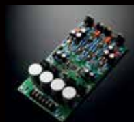
Schede digitali analogiche con circuiti di alimentazione integrati
